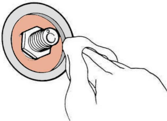
Sauberes Motorenöl auf die Dichtung des neuen Ölfilters auftragen
